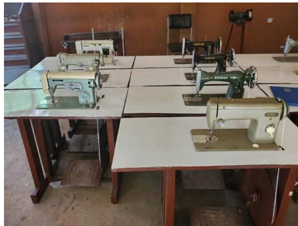
De elektrische- en handnaaimachines zijn omgetoverd tot trapnaaimachines.
